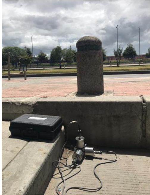
Figura 7.31 Esquema de medición de vibraciones para las tres componentes de movimiento de manera simultánea
